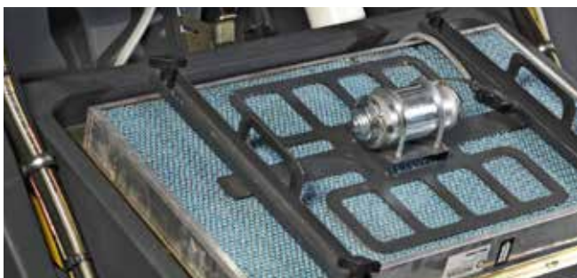
Filtre Filtru din hârtie: bun în medii uscate, cu mult praf Poliester: Excelent în medii umede, poate fi spălat, uscat și reutilizat
